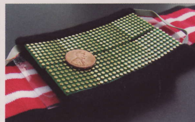
視覚障害者用のシステムを開発しています。電気刺激を用いることで数百点の触覚提示を実現しています。電気刺激による触覚提示システムとしては世界最高のものです。
