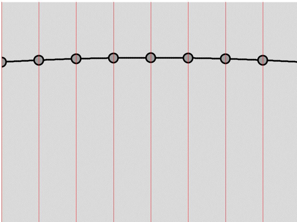
元の波形が正弦波の場合、サンプリングされたデータも正弦波となる
