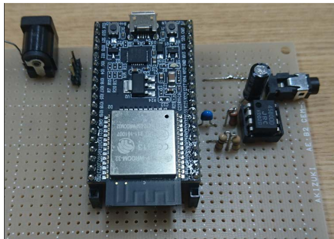
図 9 アナログ出力とオペアンプ回路
