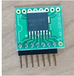
図 16 BD6222HFP のピッチ変換
