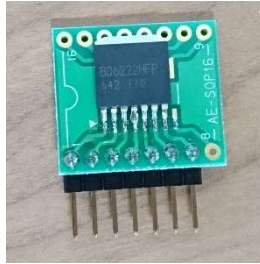
図 16 BD6222HFP のピッチ変換
