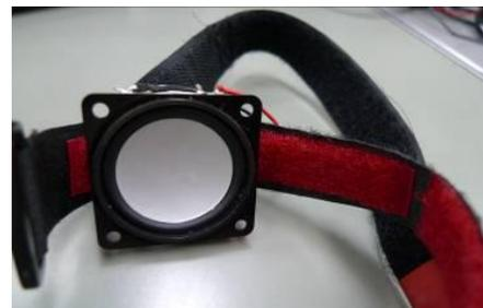
図 1 スピーカーを用いた皮膚刺激子
