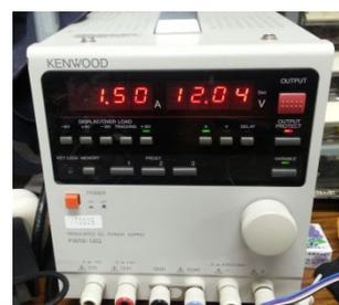
本実験では当初は電源電圧 9V、電流リミット 0.3A 程度に設定する。その後、回路上の問題がなければ電流リミットを 1.5A 程度に上げる。(電圧は 9V のままで良い。このモータドライバの最大電圧は 11V であることに注意)。
