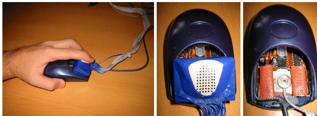
図 5.11 64 電極マウス（左）全体図（中）前面（右）電極下の力センサ
