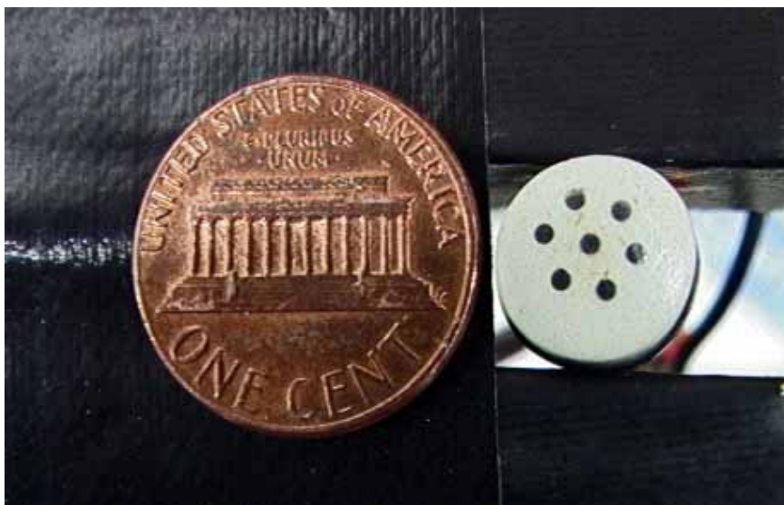
図 2.22 7 電極から構成される二次元電極
