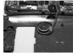
図1: アクチュエータの設置状況 PDAの筐体に貼り付けている。
