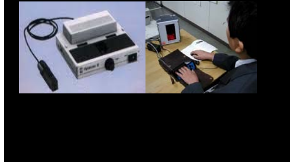
オプタコン: 視触覚変換装置 / Optacon: Vision-Tactile Converter (1976)
