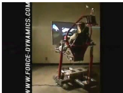
Force Dynamics製 3本の直動アクチュエータによるパラレルリンク
