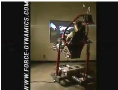
Force Dynamics製 3本の直動アクチュエータによるパラレルリンク
