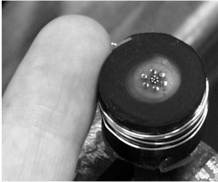
図 8.7: 試作した Smart Electrode . 周囲 6 電極は従来の直径 1mm のもの . 中心電極のみ Smart Electrode と入れ換えたもの . 左は人差指 .
