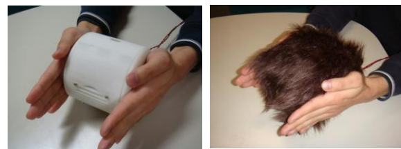
図 1 実験装置 (左)テクスチャなし, (右)テクスチャあり
