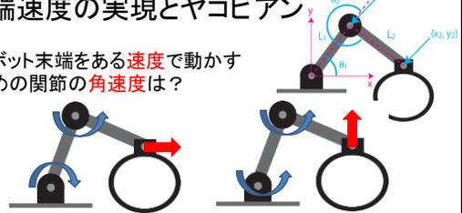
$$\begin{bmatrix} \dot{x}_2 \\ \dot{y}_2 \end{bmatrix} = \mathbf{J} \begin{bmatrix} \dot{\theta}_1 \\ \dot{\theta}_2 \end{bmatrix} \Rightarrow \begin{bmatrix} \dot{\theta}_1 \\ \dot{\theta}_2 \end{bmatrix} = \mathbf{J}^{-1} \begin{bmatrix} \dot{x}_2 \\ \dot{y}_2 \end{bmatrix}$$
