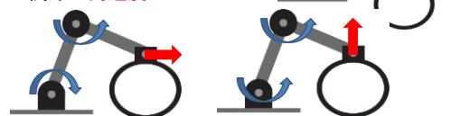
$$\begin{bmatrix} \dot{x}_2 \\ \dot{y}_2 \end{bmatrix} = J \begin{bmatrix} \dot{\theta}_1 \\ \dot{\theta}_2 \end{bmatrix} \rightarrow \begin{bmatrix} \dot{\theta}_1 \\ \dot{\theta}_2 \end{bmatrix} = J^{-1} \begin{bmatrix} \dot{x}_2 \\ \dot{y}_2 \end{bmatrix}$$
