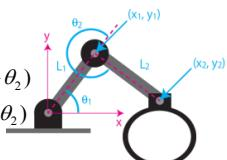
$$\begin{bmatrix} \dot{x}_2 \\ \dot{y}_2 \end{bmatrix} = \begin{bmatrix} \quad & \quad \\ \quad & \quad \end{bmatrix} \begin{bmatrix} \dot{\theta}_1 \\ \dot{\theta}_2 \end{bmatrix}$$
