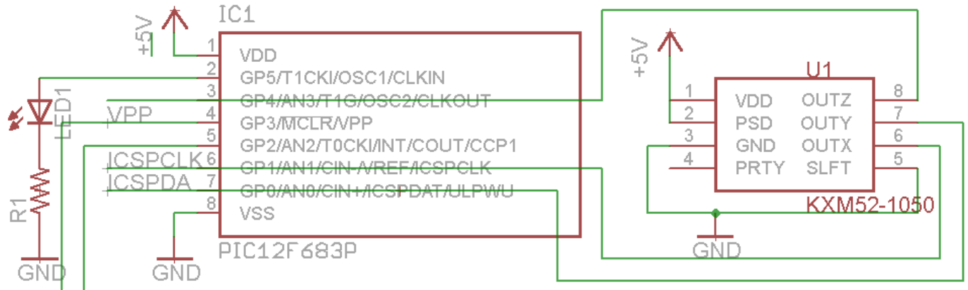
図 8 四日目課題①：加速度センサの読み取り（電源、書き込み、7セグ、シリアル通信部は省略）
