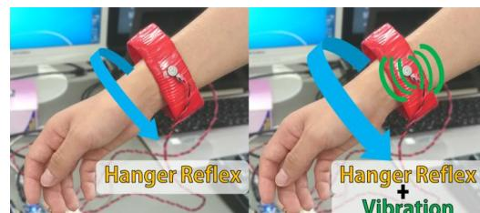
図 2 ハンガー反射時の振動提示
