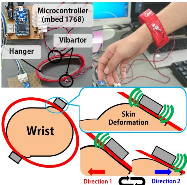
図 3(左) システム構成 (右) 装着図 (下) 手首断面模式図：手首用ハンガーによって皮膚せん断変形を起こし、振動によって変形量は増減する。
