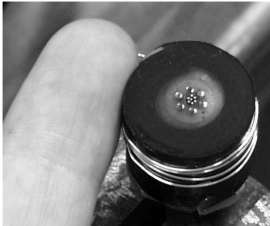
図 8: 試作した Smart Electrode. 周囲 6 電極は従来の直径 1mm のもの、中心電極のみ Smart Electrode と入れ換えたもの。左は人差指。
