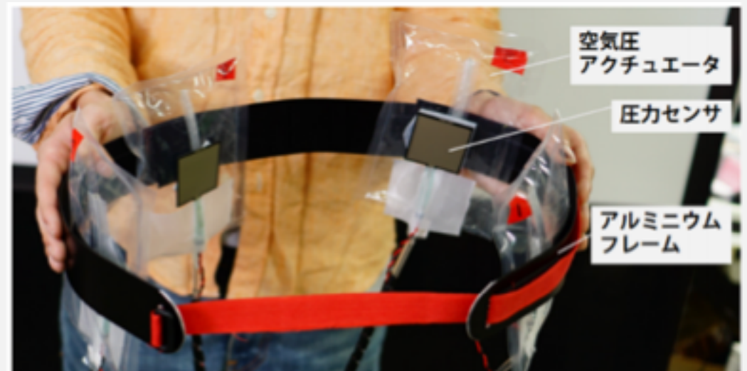
今ら、ハンガー反射を用いた腰部への回旋・並進力提示デバイス, 2016
