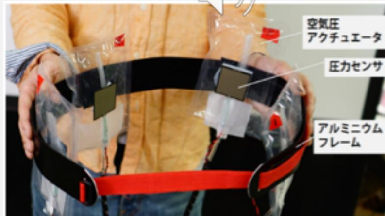
今ら, ハンガー反射を用いた腰部への回旋・並進力提示デバイス, 2016
