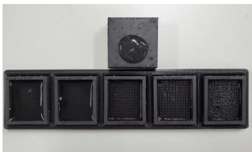
図 3: 使用したスライムと高さの異なるピンアレイで刺突したスライム(左から-0.50, -0.25, 0.00, 0.25, 0.50 mm)
