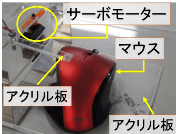
図 2 先行研究で提案したマウス型デバイス[16]
