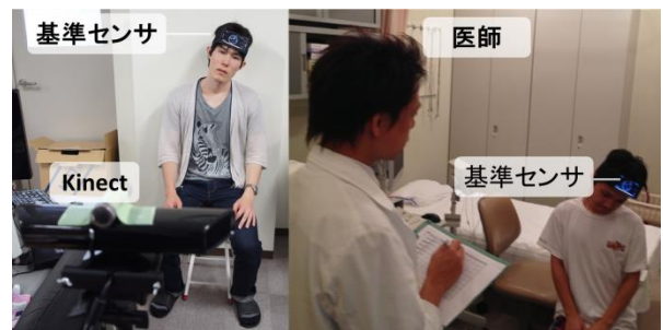
図 9 基準センサと Kinect システムによる計測の様子(左) 基準センサと医師の目視による計測の様子(右)
