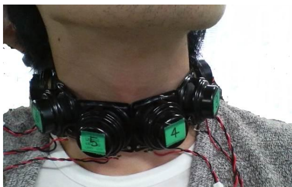
図 2 頸部に取り付けたスピーカ Fig. 2 Speakers placed on neck
