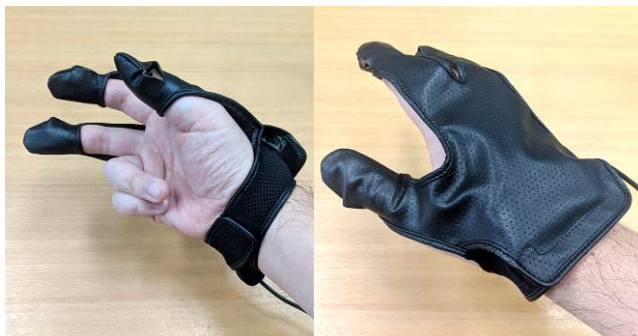
図 1 3本指用圧力・温度分布計測センサ外観
