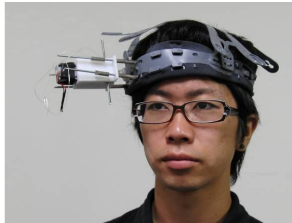
図 4 1 点刺激頭部回旋装置
