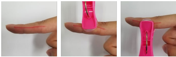
図 2 洗濯ばさみの圧迫により生じる皮膚変形 甲側から挟むと伸展方向に、掌側から挟むと屈曲方向に皮膚変形が生じている
