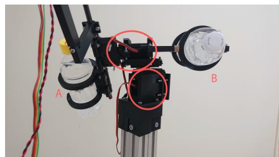
図 4 釣竿とデバイスの接続部
