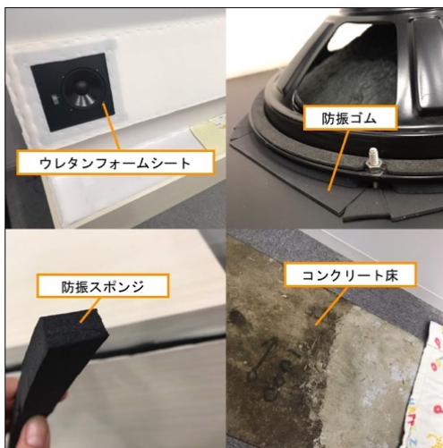
図4 振動対策：プロトタイプシステム断面図（上）、実際の写真（下）
