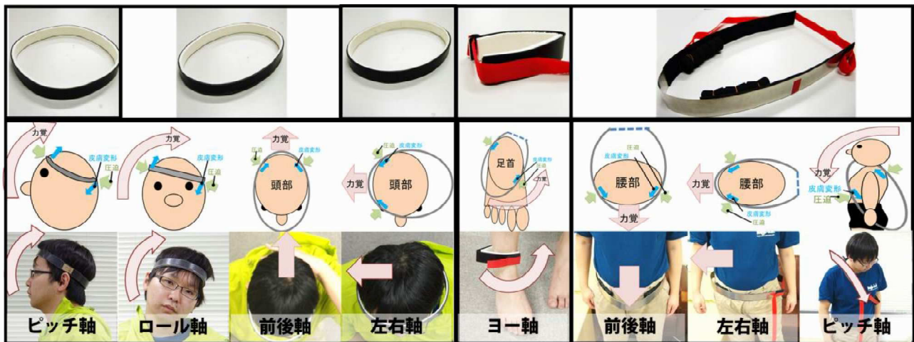
図 1 各所用力覚提示デバイス：(左)各軸用の頭部用デバイス、(中)足首用デバイス、(右)腰部用デバイス
