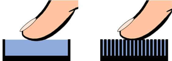
図 1: スライムの表面（左）とピンアレイを刺突することで生じる凹凸がある表面（右）で平滑感が変わる
