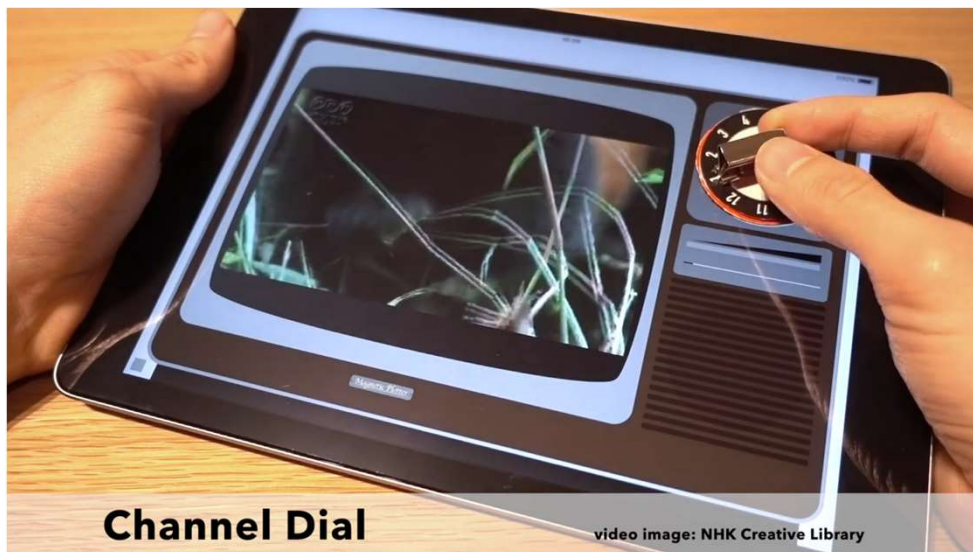
(CHI2019) Magnetact: Magnetic-sheet-based Haptic Interface for Touch Devices, Kentaro Yasu. https://www.youtube.com/watch?v=v5s1byAfocI シート状磁石によるタブレット上の触感提示。カチカチ感など。
