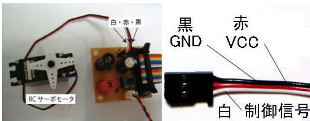
図 8 RC サーボモータの接続（向きに注意）
