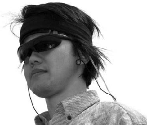
図 3 額装着型電気触覚ディスプレイを用いた視触覚変換
