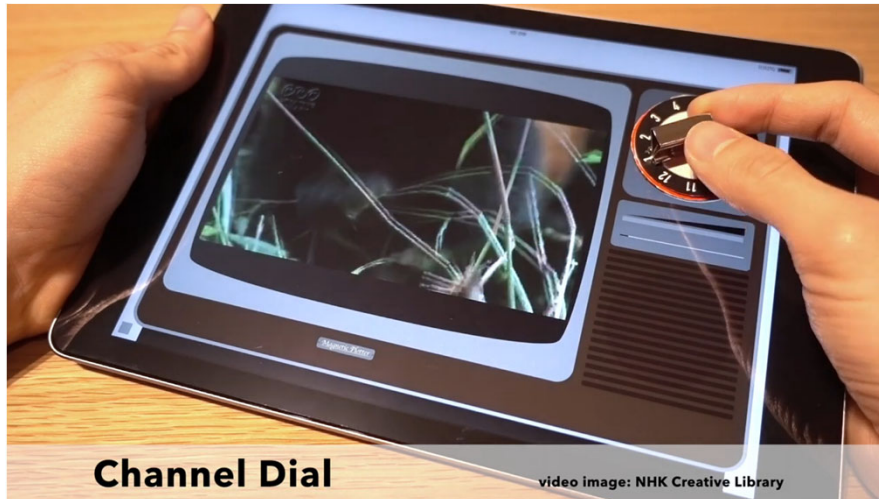
(CHI2019) Magnetact: Magnetic-sheet-based Haptic Interface for Touch Devices, Kentaro Yasu. https://www.youtube.com/watch?v=v5s1byAfoc シート状磁石によるタブレット上の触感提示。カチカチ感など。
