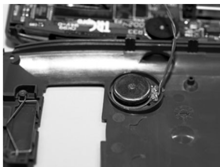
図 1: アクチュエータの設置状況 PDA の筐体に貼り付けている。
