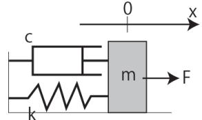
●線形な微分方程式で記述されるシステムでは、正弦波の入力は「振幅」と「位相」を変えるものの、同じ周波数の正弦波で応答される。
