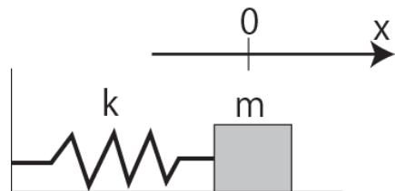
$$\begin{bmatrix} x_n \\ v_n \\ a_n \end{bmatrix} = \begin{bmatrix} 1 & dt & 0 \\ 0 & 1 & dt \\ -k/m & 0 & 0 \end{bmatrix} \begin{bmatrix} x_{n-1} \\ v_{n-1} \\ a_{n-1} \end{bmatrix} = \mathbf{A}\mathbf{x}_{n-1} = \cdots = \mathbf{A}^n \mathbf{x}_0$$
